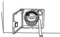
4. Öffnen Sie die Pumpe, indem Sie den Deckel gegen den Uhrzeigersinn drehen. Entfernen Sie den Deckel mit dem Sieb.
