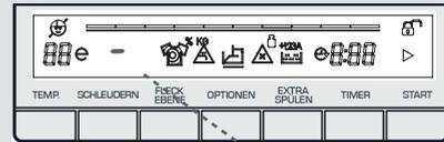
Wenn Sie die gewünschte Schleuderdrehzahl verpasst haben, können Sie durch ständiges Drücken auf die Schleuderdrehzahl Einstelltaste, auf die vorgesehene Drehzahl zurückzukehren.
