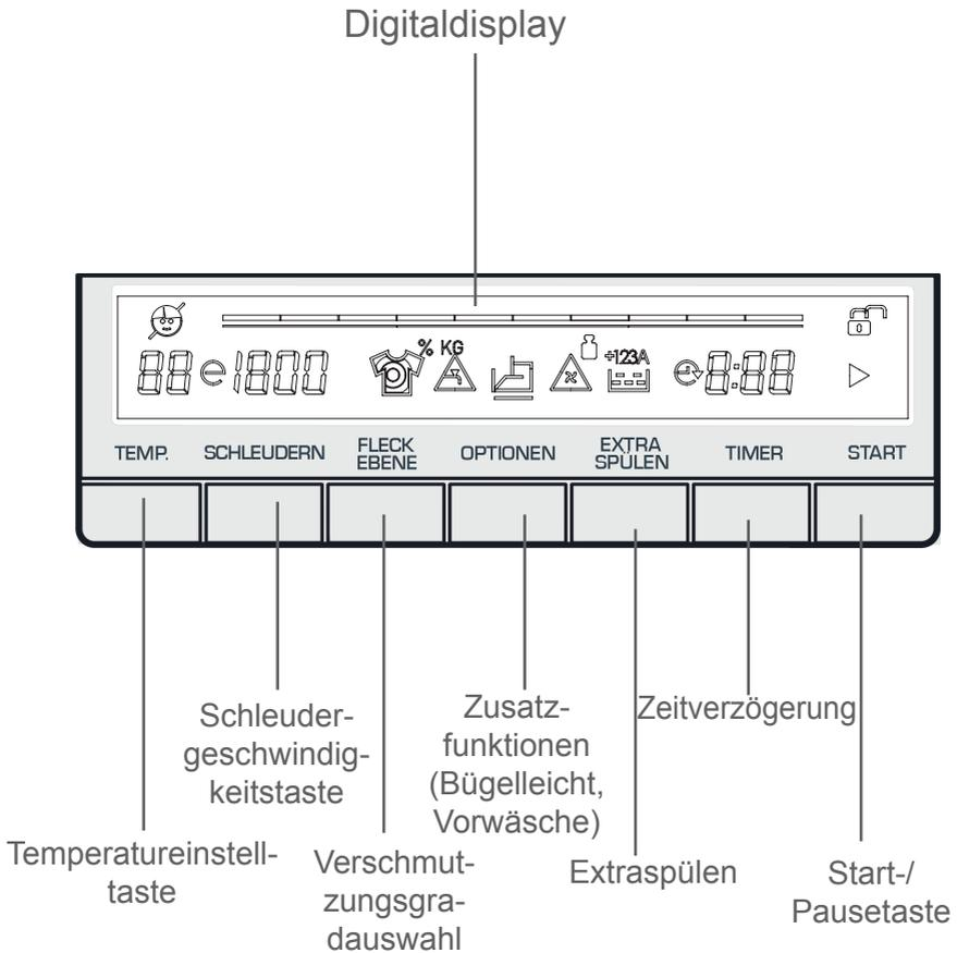
Im Display werden Wassertemperatur, Schleudergeschwindigkeit, Abschlusszeit, Türsperrezustand, gewählte Zusatzfunktionen und der Waschprogrammfortschritt (
