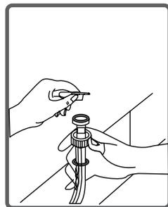
**WARNUNG:** Die Filter der Wassereinlassventilen können wegen kontaminiertes Leitungswasser oder das Fehlen von notwendigen Wartungsarbeiten verstopft werden oder die Ventile versagen, wodurch in Ihre Maschine kontinuierlich Wasser eindringen kann.
