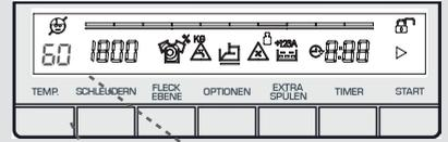
Wenn Sie ein neues Programm wählen, wird auf der Waschwassertemperaturanzeige die maximale Waschwassertemperatur, die Sie gewählt haben angezeigt.
