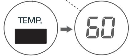
Sie können schrittweise die Waschwassertemperatur zwischen der maximalen Temperatur und Kaltwäsche (--) durch Drücken der Waschwassertemperatur Einstellungstaste verringern.
