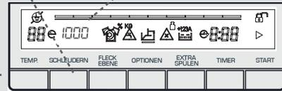
Sie können die Drehzahl des gewählten Programms durch Drücken der Drehzahl Einstellungstaste schrittweise zwischen der maximalen Schleuderdrehzahl und Schleudern abbrechen (--)-Option reduzieren.
