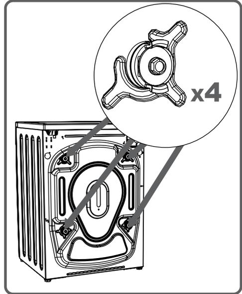
Die Transportsicherungsschrauben sollten mit einem passenden Schraubenschlüssel durch Drehen gegen den Uhrzeigersinn gelöst werden.
