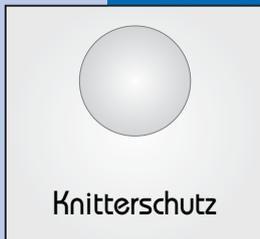
Durch Drücken dieser Taste werden die Wäschestücke in der Trommel noch für weitere dreißig Minuten bewegt, damit sie nicht knittern. Bei dieser Funktion erreicht die Schleuderdrehzahl maximal 800 Umdrehungen. Diese Funktion steht für das Programm "WOLLE" nicht zur Verfügung.
