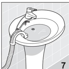
\* Wird das Wasser in das Spülbecken oder in einen anderen Abflußbereich geleitet, ist das freie Rohrende an der Biegungsstelle mit dem der Lieferung beigelegten Haken zu verstärken. Nun ist das Rohr am Spülbeckenrand mit dem Haken sicher zu befestigen [Abb. 7]. Das Wasser muß vom Becken zügig abfließen.
