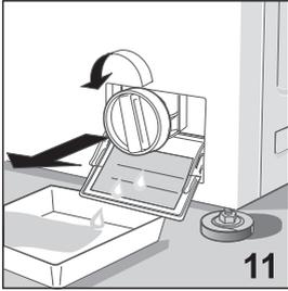
Damit das im Filter gebliebene Wasser nicht auf den Boden fließt, ein Tuch hinlegen oder einen flachen Teller hinstellen. Die Klappe des Filters öffnen und diesen gegen den Uhrzeigersinn drehen, damit er herausgenommen werden kann [Abb. 11].
